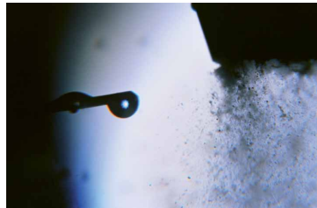
Bild 13: Austrittskante mit Beaufschlagung von Ringspaltluft
