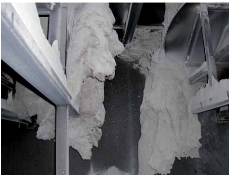
Bild 4: Anbackungen aufgrund unverdampfter Tropfen
