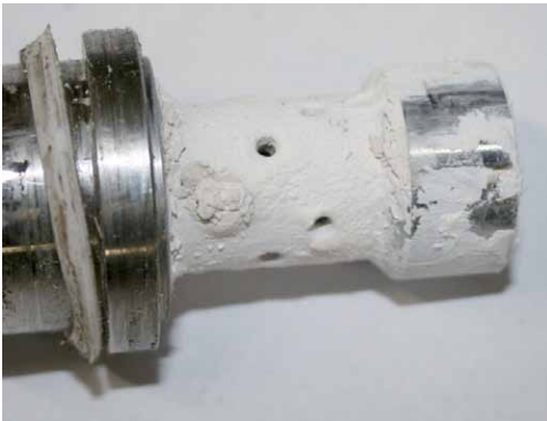
Bild 19: Düse vor automatischer Reinigung
