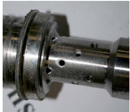
Bild 20: Düse nach automatischer Reinigung
