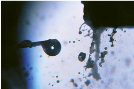
Bild 12: Austrittskante Zweistoffdüse ohne Beaufschlagung von Ringspaltluft
